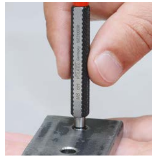
Prüfung mit Präzisions-Gewindelehrring Checking with Precision Thread Plug Gauge
